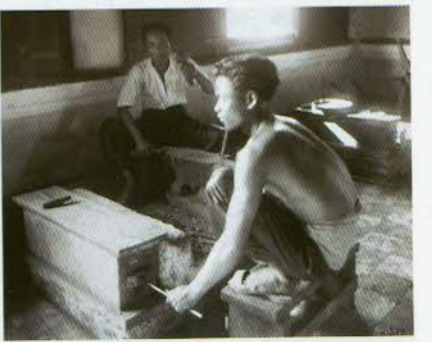
រូបលេខ១០២៖ ស្នប់បុរាណ (រូបថតរោងជាងជួសជុលចម្លាក់ថ្មនៃសារមន្ទីរជាតិ ភ្នំពេញ)។
