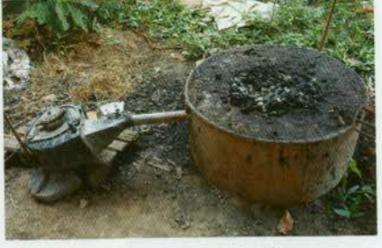
រូបលេខ១០៤៖ ស្នប់ប្រើម៉ូទ័រកែច្នៃពីកង្ការម៉ាស៊ីនត្រជាក់ឡាន។
